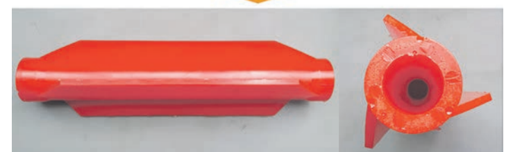
Замена элементов рессорного центратора на полиуретановый
