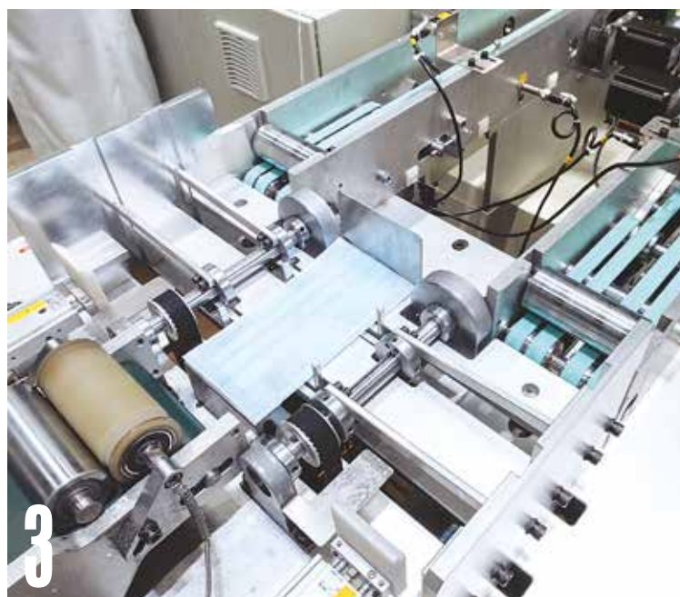
4 Далее маски поступают в зажимные каретки, после чего в автоматическом режиме к ним крепится лента. На данной линии установлены два узла приваривания ушных петель
