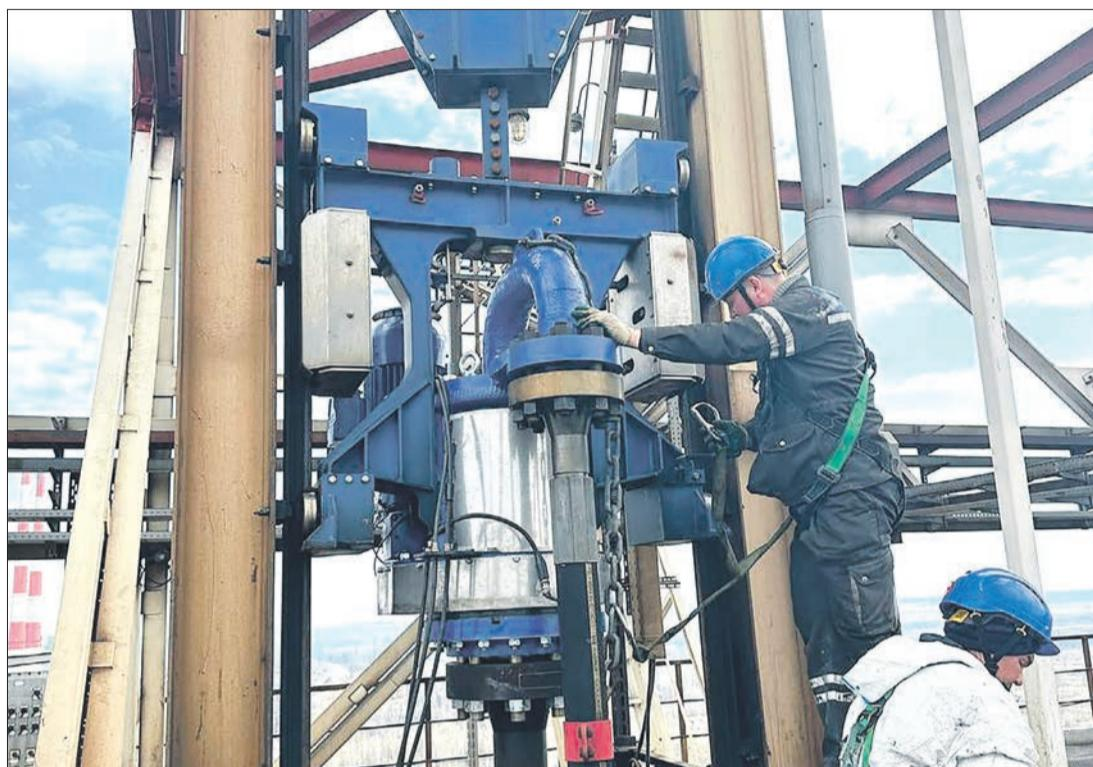
Привод буровой штанги — один из ключевых узлов сложного оборудования на установке замедленного коксования. Он служит для удаления нефтяного кокса из реактора путём бурения, а именно: насос гидорезки подаёт воду под большим давлением на привод и дальше на инструмент. Тем самым происходит бурение и выгрузка нефтяного кокса из реактора в коксовую яму.
