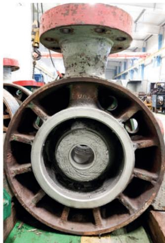
На участке по ремонту ЦНС и ГНУ цеха №2 ООО «РИНПО» после проведения разбора, пескоструйной обработки и дефектации деталей и узлов насосов ЦНС-180 определена проблема износа посадочной поверхности напорной крышки, приводящая к отбраковке. По этой причине за последние два года было отбраковано и приобретено взамен три напорные крышки для ЦНС-180. После анализа экономической стороны проблемы
