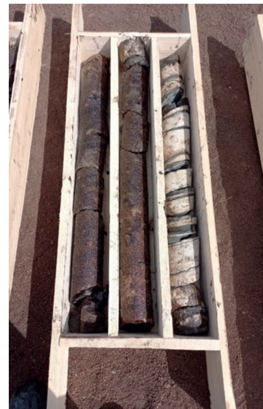
Керн со скважины 1122 Нагорного месторождения (глубина отбора 1878-1881 м)
