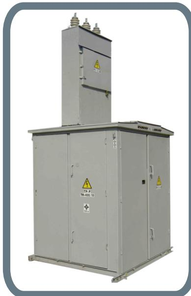
Комплектная трансформаторная подстанция киоскового типа (КТПК) предназначена для приема электрической энергии промышленной частоты напряжением 6 (10) кВ, преобразования ее в электроэнергию напряжением 0,4 кВ и снабжения потребителей общепромышленного назначения.
