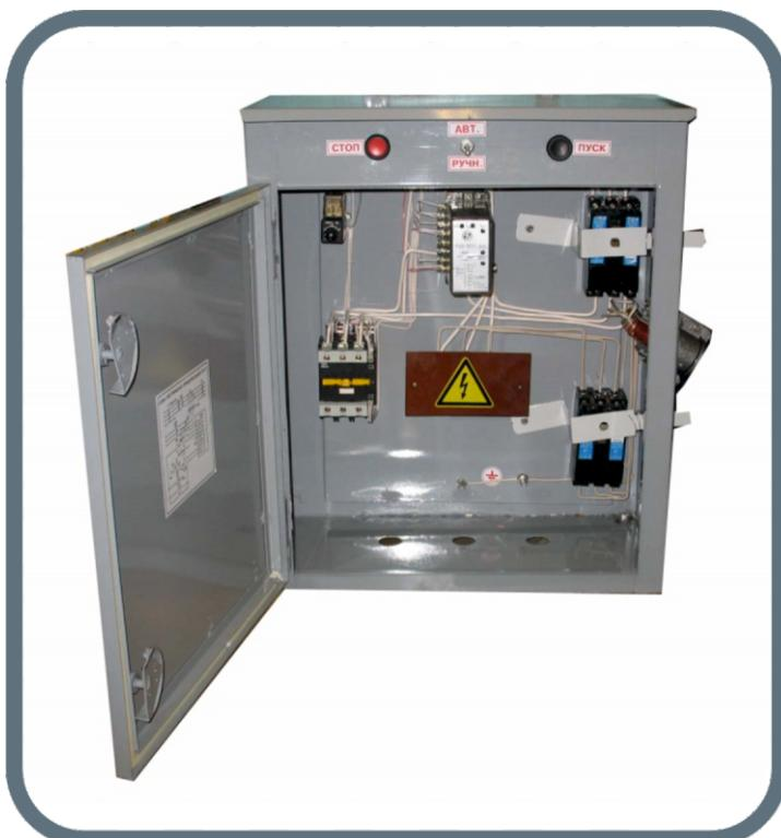
Станция управления с контроллером РЗД предназначена для управления электродвигателем станка-качалки в ручном, автоматическом и программном. СУ РЗД обеспечивает защиту трехфазных асинхронных электродвигателей и индикацию причин аварии посредством реле РЗД при возникновении следующих аварийных режимов:
