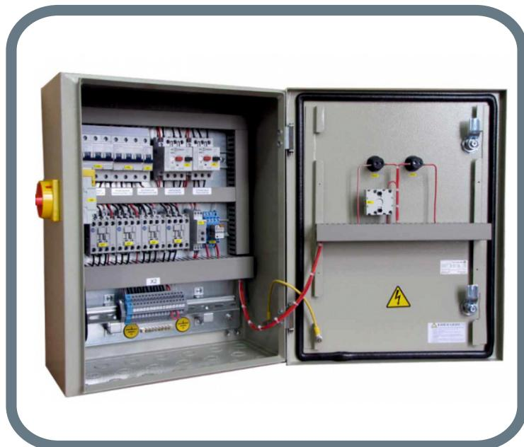
Щит станции управления ЩСУ-0,4 кВ предназначен для приема, распределения и учета электрической энергии в электроустановках напряжением 380/220 В трехфазного переменного тока частотой 50 - 60 Гц в сетях с глухозаземленной нейтралью, а также для защиты отходящих от ЩСУ распределительных и групповых цепей при перегрузках и коротких замыканиях.
