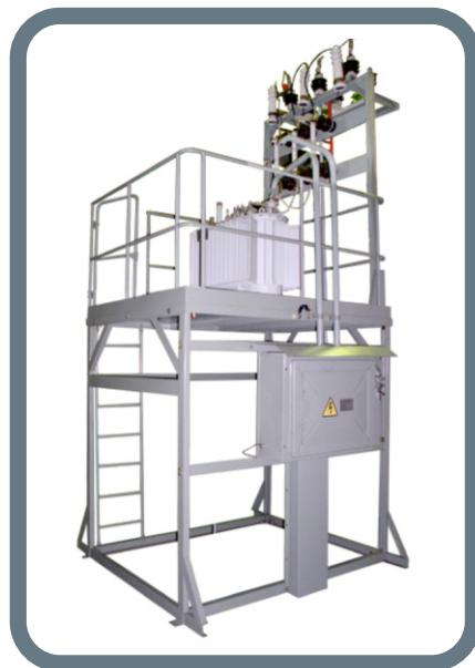
Комплектная трансформаторная подстанция универсальная (КТПУ) представляют собой однотрансформаторную подстанцию наружной установки и предназначена для приема, преобразования и распределения электрической энергии однофазного или трехфазного переменного тока частотой 50 Гц. Высшее номинальное напряжение 6 (10) кВ, низшее – 0,23; 0,4 кВ.
