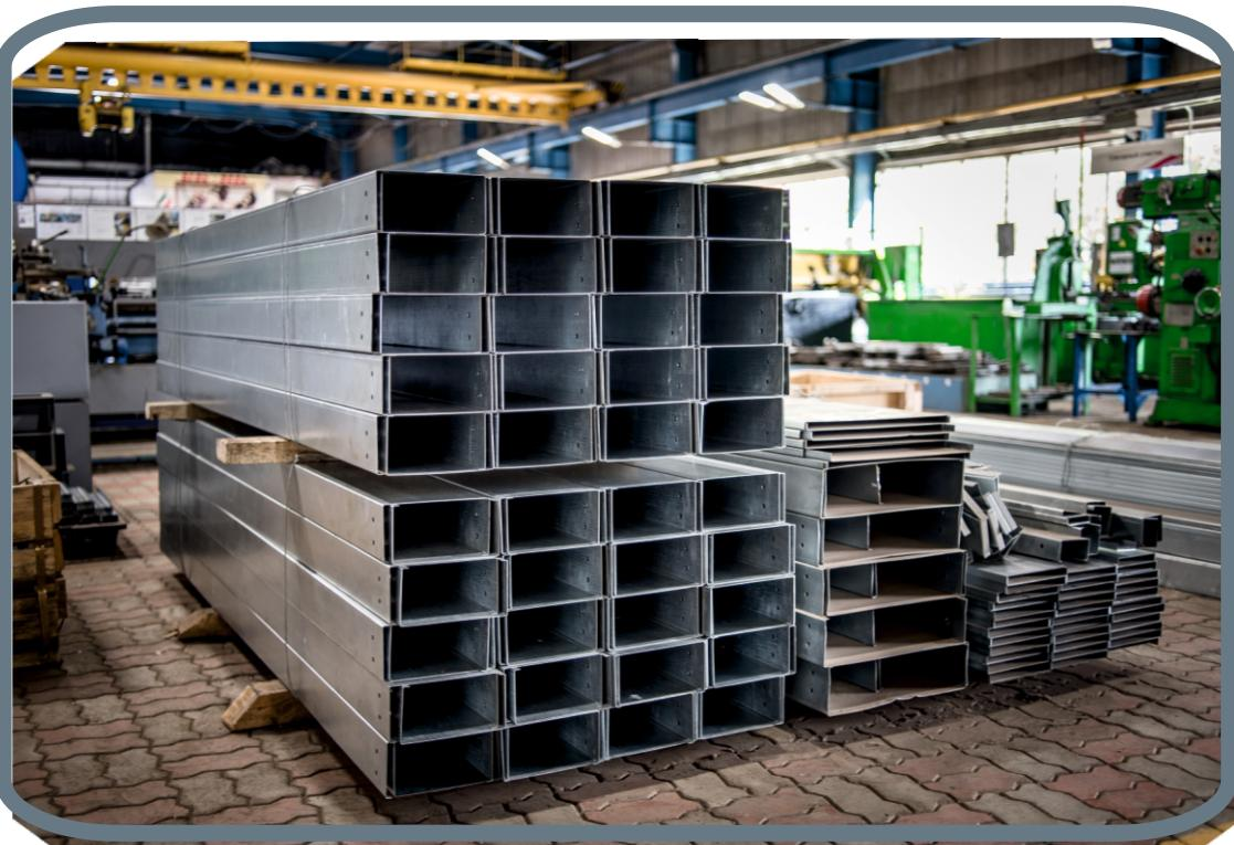
В номенклатуру коробов входят готовые для сборки элементы, обеспечивающие создание трассы с необходимыми поворотами и разветвлениями в горизонтальной и вертикальной плоскостях: короба прямые, угловые, тройниковые. Размеры коробов могут варьироваться от желания заказчика.
