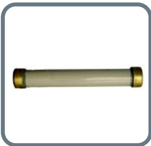
Предохранители высоковольтные токоограничивающие серии ПКТ предназначены для защиты силовых трансформаторов, воздушных и кабельных линий, в сетях трехфазного переменного тока частоты 50 Гц с номинальным напряжением от 3 до 10 кВ и рабочими токами от 2 до 80 А.
