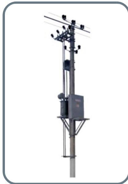
Комплектная трансформаторная подстанция столбового исполнения (КТПС) представляют собой однотрансформаторную подстанцию наружной установки тупикового типа, устанавливаемую на ж/б или металлических стойках и предназначена для приема, преобразования и распределения электрической энергии однофазного или трехфазного переменного тока частотой 50 Гц. Высшее номинальное напряжение 6 (10) кВ, низшее – 0,23; 0,4 кВ.
