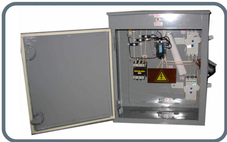
Станция управления с контроллером КСКН предназначена для управления электродвигателем станка-качалки в ручном, автоматическом и программном режимах. СУ КСКН обеспечивает непрерывный контроль тока асинхронных электродвигателей и защитного электродвигателя при возникновении аварийных режимов посредством контроллера КСКН-7.
