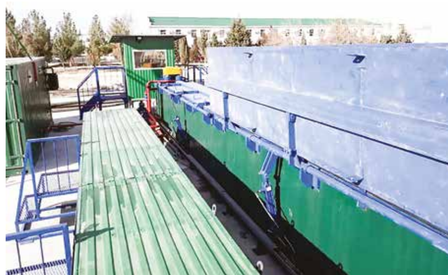
Установка активаторной мойки труб НКТ
