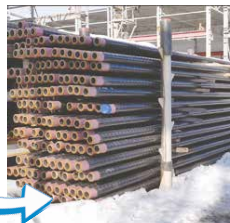
ЭТАП 6. Трубы перемещают на склад готовой продукции
