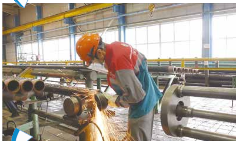
ЭТАП 2. Происходит механическая обработка концов стальных труб
