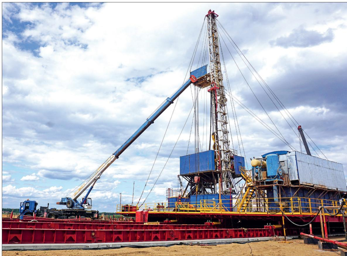
Новая система передвижки буровой установки типа «слайдер» позволяет сокращать ВМР, повысить уровень промышленной безопасности и охраны труда. / ФОТО: АДЕЛЬ ГАЗИЗУЛЛИНА.
