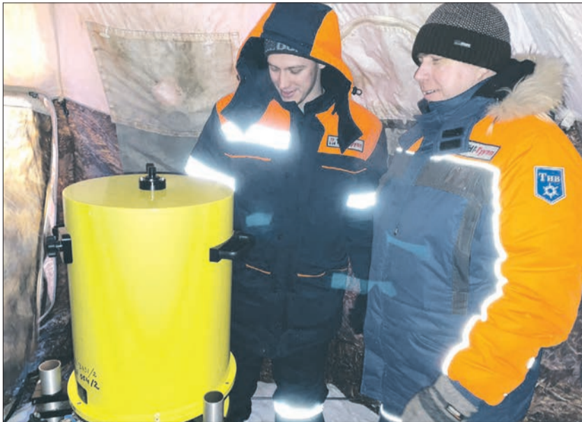
Установка абсолютного гравиметра на пункте измерений
